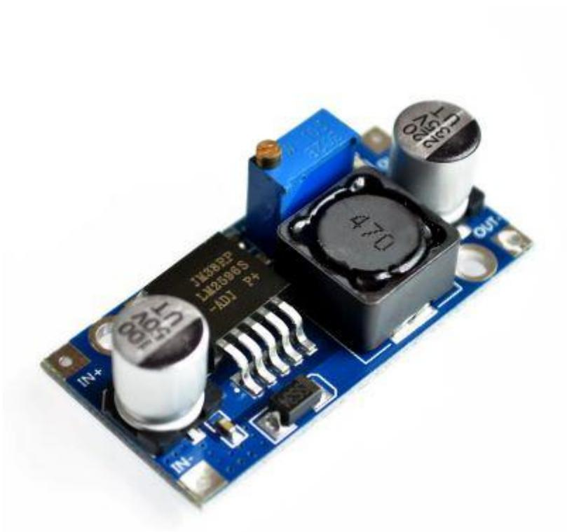
Mit dem Spannungswandler können wir eine Gleichspannung in eine **niedrigere** Spannung umwandeln. Da wir für die Motoren 6-9V benötigen, der Pico und die elektronischen Komponenten aber nur 3,3V - 5 V vertragen, betreiben wir den Roboter mit einer 9V Batterie und nutzen den Spannungswandler für den Pico. Der Pico wiederum stellt 3,3V für den Betrieb der anderen Teile bereit.
