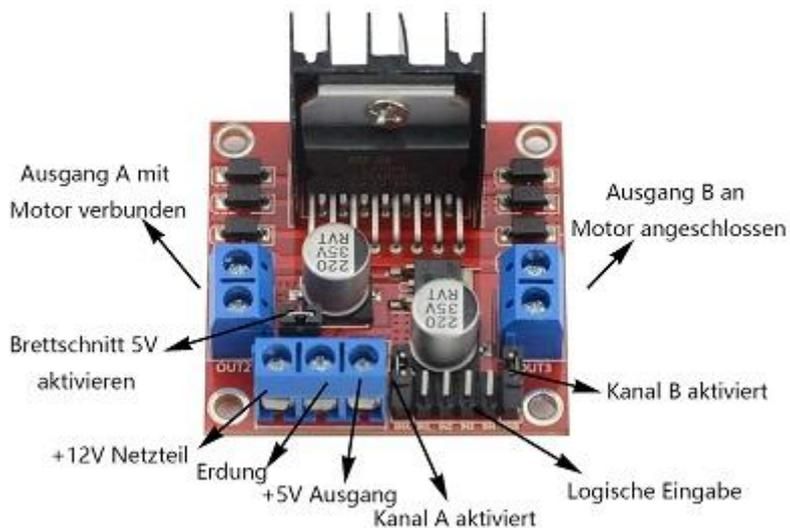
Dieser Motortreiber beinhaltet gleichzeitig einen Spannungswandler, der genau 5V Gleichspannung liefert.
