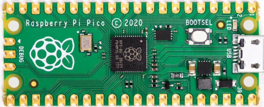
Der Pico ist, wie die meisten elektronischen Teile, sehr empfindlich gegen Verpolung oder Überlastung oder Kurzschlüsse. Daher muss man immer sehr sorgfältig alle Verbindungen überprüfen, bevor eine Spannung angelegt wird.
