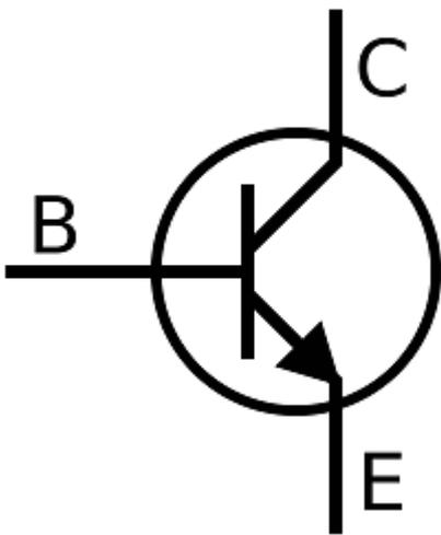
Das heißt, mit einem Transistor kann man mit einer niedrigen Spannung eine größere Spannung regulieren. Das kann ein einfacher Schaltvorgang sein oder die relative Regelung einer Spannung. Damit ist der Transistor in seiner Grundfunktion ein Verstärker. In einer digitalen Schaltung wird der Transistor auch wieder nur an- oder ausgeschaltet. Die Regelung der Helligkeit einer LED oder
